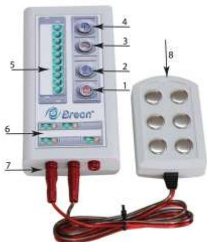
1. Кнопка включения/выключения электропитания.
